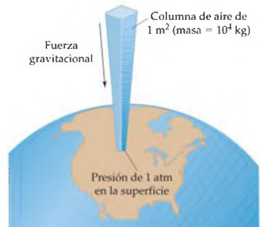
▼ Figura 10.1 Presión atmosférica. Ilustración de la forma en que la atmósfera terrestre ejerce presión sobre la superficie del planeta. La masa de una columna de la atmósfera con una sección transversal de exactamente 1 \text{ m}^2 , y que se extiende hasta la parte superior de la atmósfera ejerce una fuerza de 1 \times 10^5 \text{ N} .
